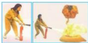
左手提着喷管，右手用力压下压把，对着火焰根部喷射，并不断推前，直至把火焰喷灭
